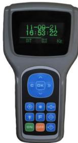
此应用中，其与大屏幕一样可同步显示吊秤称重值。当吊秤未开而仪表开机时将显示当前的日期和时间。下面简要说明 P2 表的使用方法：
